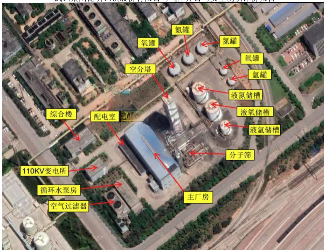
图 2-2 1#空分制氧站平面布置图
