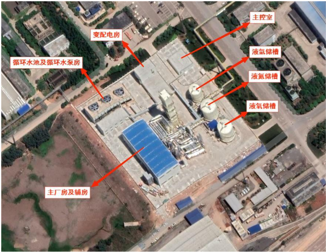
图 2-3 2#空分制氧站总平面布置图
